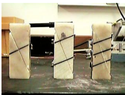
Figura 8: Montagem final para ensaio de pregagem.
