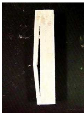
Figura 5: Foto de um provete de esbelteza 5 mostrando fenómenos de encurvadura.
