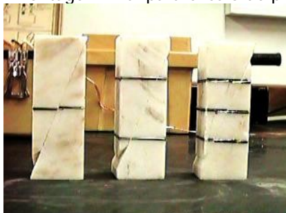
Figura 9: Montagem final para ensaio de amarração.
