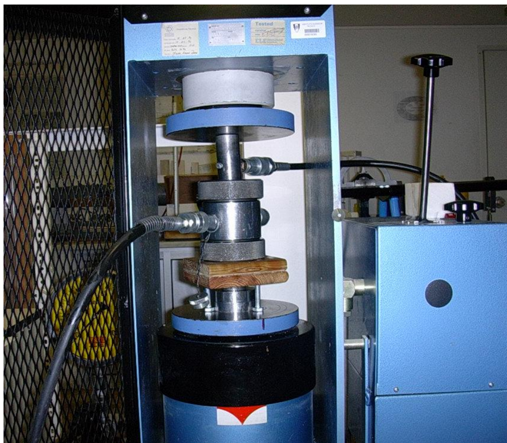
Figura 5 – Câmara triaxial, com provete em ensaio
