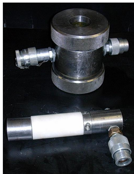
Figura 4 – Câmara triaxial e provete montado
