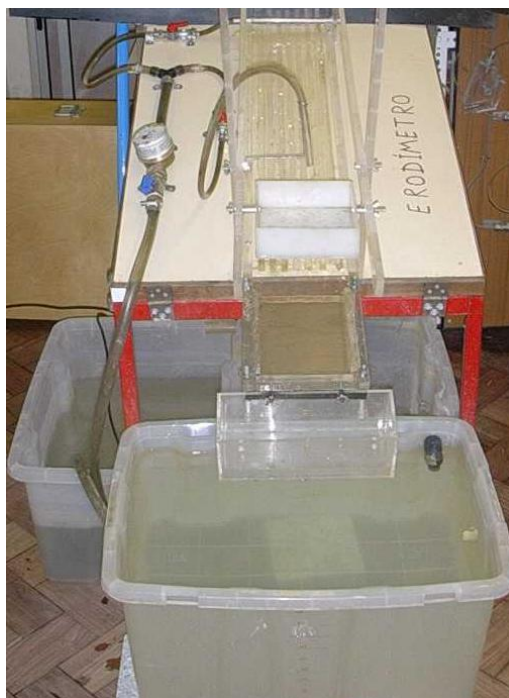
Figura 2 – Provete em ensaio de erodibilidade
