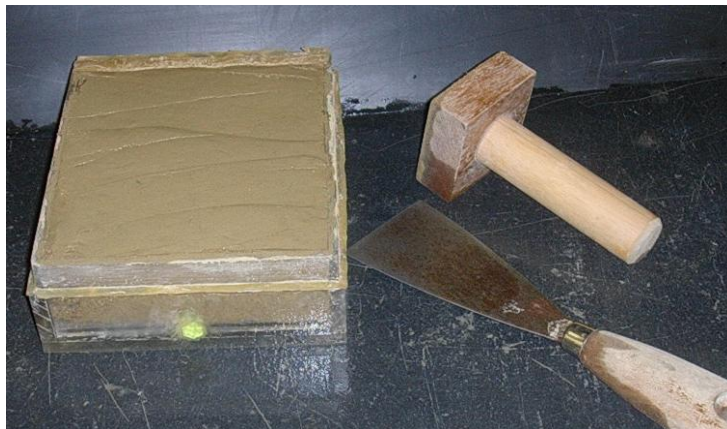
Figura 1 – Preparação do provete para ensaio de erodibilidade
