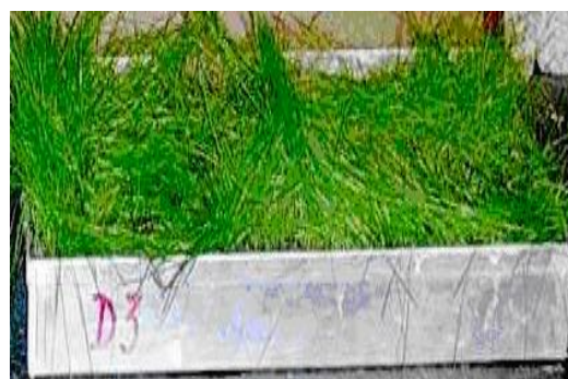
Figura 3 – Preparação de amostras para ensaio de provetes com cobertura vegetal (relva)
