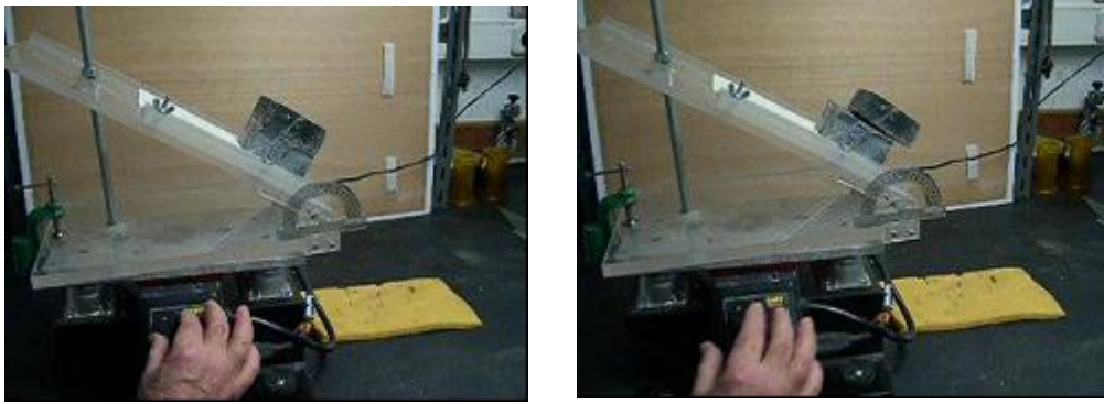
Figura 3 – Simulação da instabilidade dinâmica de blocos de rocha em taludes
