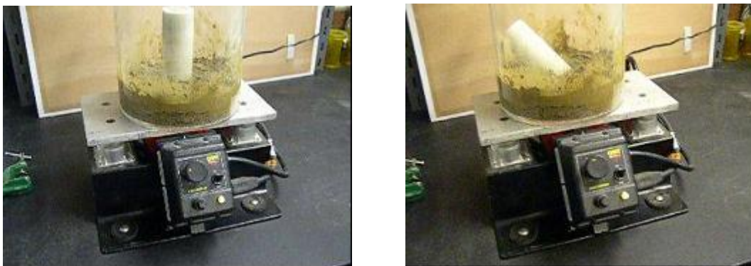
Figura 2 – Simulação da instabilidade dinâmica por liquefacção de um solo
